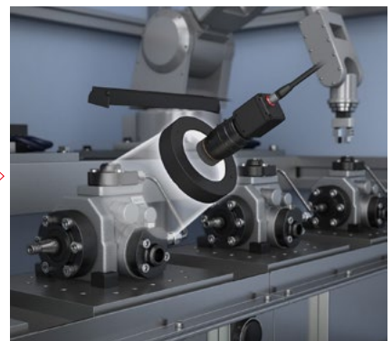
切換為設定 0002 後，執行金屬加工面的外觀檢測
