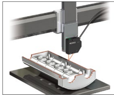
量測液體密封劑的高度
