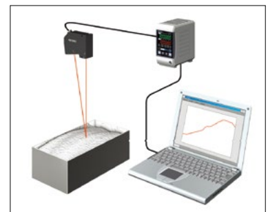
量測聚氨酯泡沫的高度
