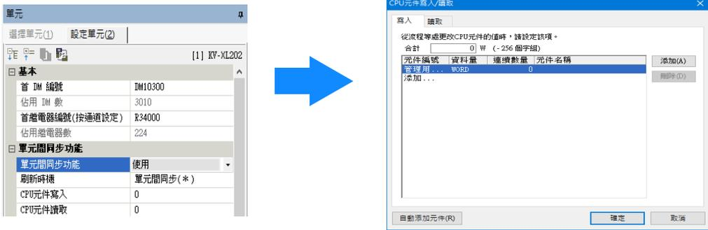
單擊“CPU 元件寫入／讀取”對話視窗的“添加(A)”按鈕後，顯示“CPU 元件選擇”對話視窗，選擇要讀取、寫入的元件。另外，單擊“CPU 元件寫入／讀取”對話視窗的“自動添加元件(R)”按鈕後，將“KV-XL202/XL402”的流程中使用的元件，自動登錄到 CPU 元件寫入／讀取的元件。
