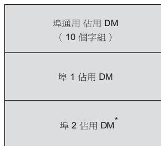
\* 將埠 1 及埠 2 同時設定為 PLC 連接模式時，不佔用埠 2，透過埠 1 的輸出繼電器/輸入繼電器/佔用 DM 對埠 1 和埠 2 統一進行控制。
