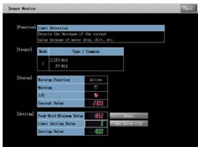
目標感測器存在警告功能的設定時，可從詳細畫面的警告功能所準備的按鈕打開。
