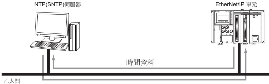
在網路中校正時間時，一般情況下，使用網路中路徑較近的 NTP 伺服器，如局域網中的 NTP 伺服器或建 NTP 伺服器功能的路由器等。
