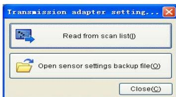
透過“從掃描列表讀取”或者“打開感測器設定備份檔案”，選擇傳送適配器設定中使用的 EtherNet/IP 適配器，啟動傳送適配器設定功能。
