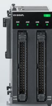
高速定位單元 KV-SHO4PL
