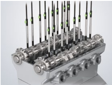
■ 檢查凸輪軸的擺幅
