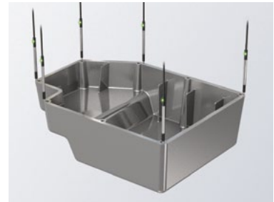
■ 檢查油底殼的平整度
