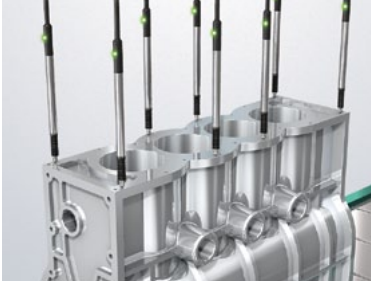
■ 檢查引擎框架的平整度
