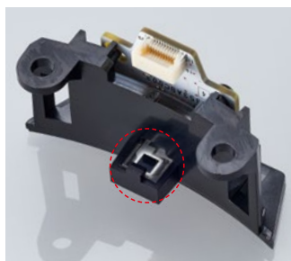
在照明內部集成光電二極體和補正電路
