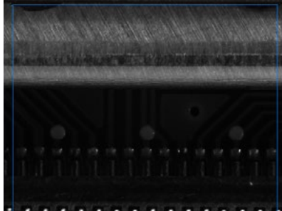
檢測範圍在工件深處，光量不足，無法識別基板圖形。
