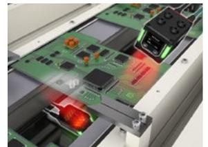
讀取多層印刷電路板兩面的條碼
