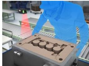
砂型鑄造用木型的投入防呆裝置
