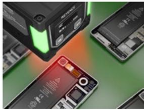
讀取軟性印刷電路板上的極小條碼
